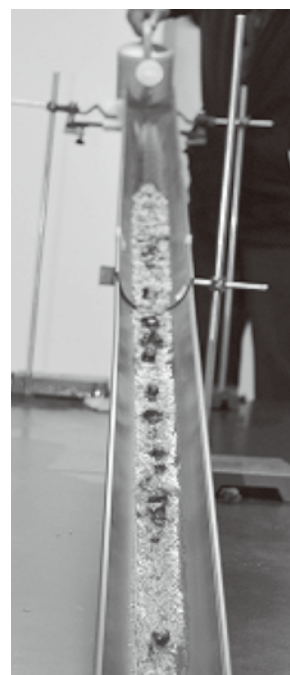
土石流のモデル実験 堰を外すと、大きな石が一気に先頭に出る
