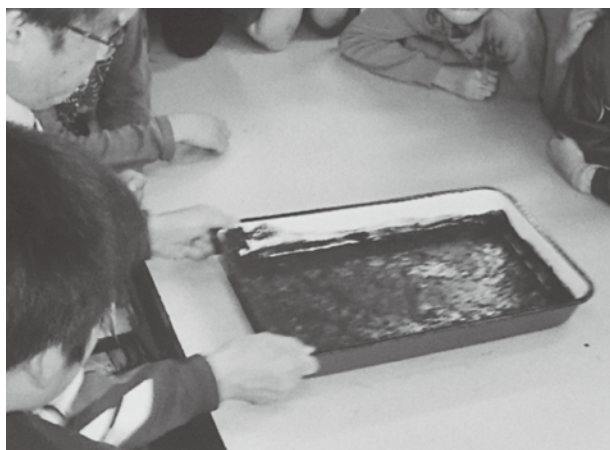
液状化現象のモデル実験 乾いた部分が均一化して泥状になる。
