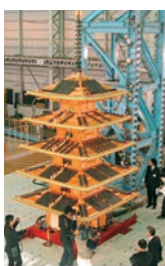
五重塔の模型による耐震実験(防災科学技術研究所、平成27年度) 震動計(ばり)が震動を感知してゆれを吸収し、高い耐震性を示した。
