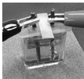
図1 塩化銅水溶液の電気分解の様子
