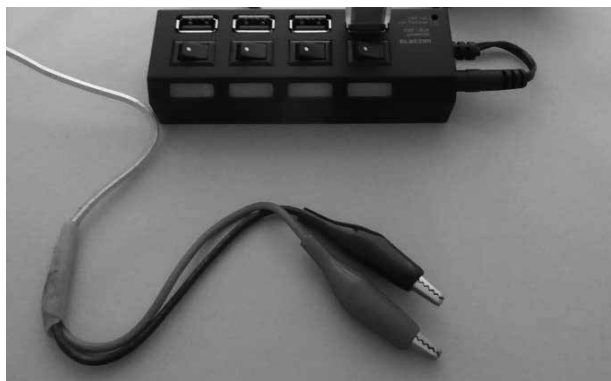
図3 直流電源として用いるUSBハブ
