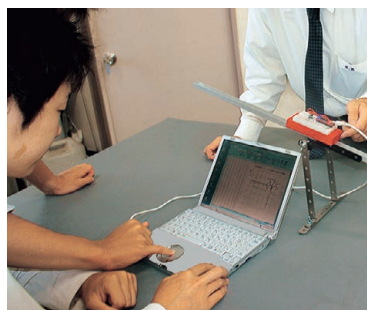
図1 斜面をすべりおろる物体の加速度の測定
