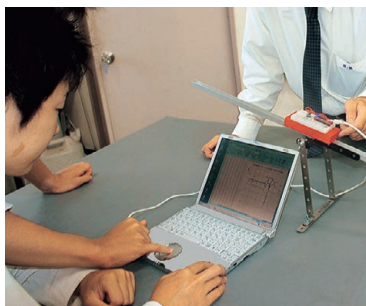
①図1 斜面をすべりおろる物体の加速度の測定
